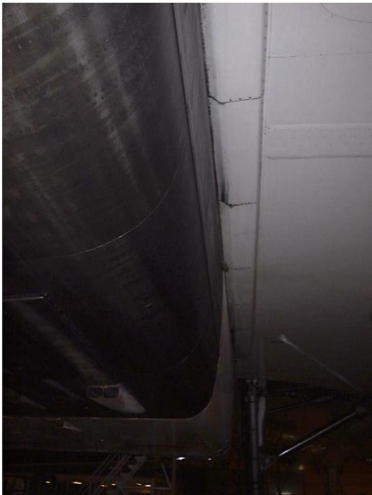
**Figure 39:** Photographie du raccord entre la nacelle moteurs gauche et l'aile d'un Concorde, vu vers l'avant de l'appareil. Photographie BEA prise sur un Concorde d'Air France à Roissy le 8/12/2000.
