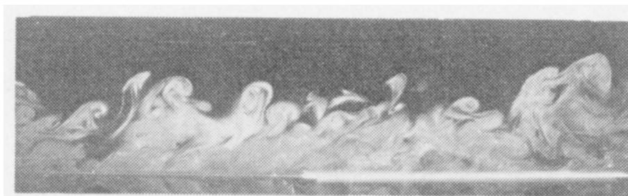
**Figure 30:** Visualisation d'une couche limite turbulenteensemencée par de la fumée. De larges structures cohérentes sont apparentes sur toute l'épaisseur de la couche limite (Falco 1977).
