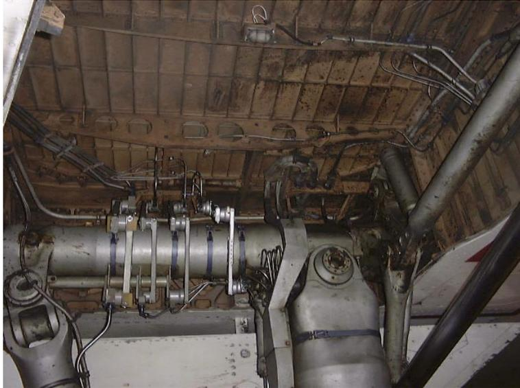
**Figure 24:** Photographie du puits du train principal gauche d'un Concorde. L'avant de l'appareil se trouve vers la droite de l'image. Les câbles électriques sont essentiellement situés au fond du puits et paraissent protégés d'impacts de débris issus de la roue 2 par les contrefiches (deux des trois contrefiches sont visibles, la troisième est clairement apparente sur la photographie 22). Photographie BEA prise sur un Concorde d'Air France à Roissy le 8/12/2000.
