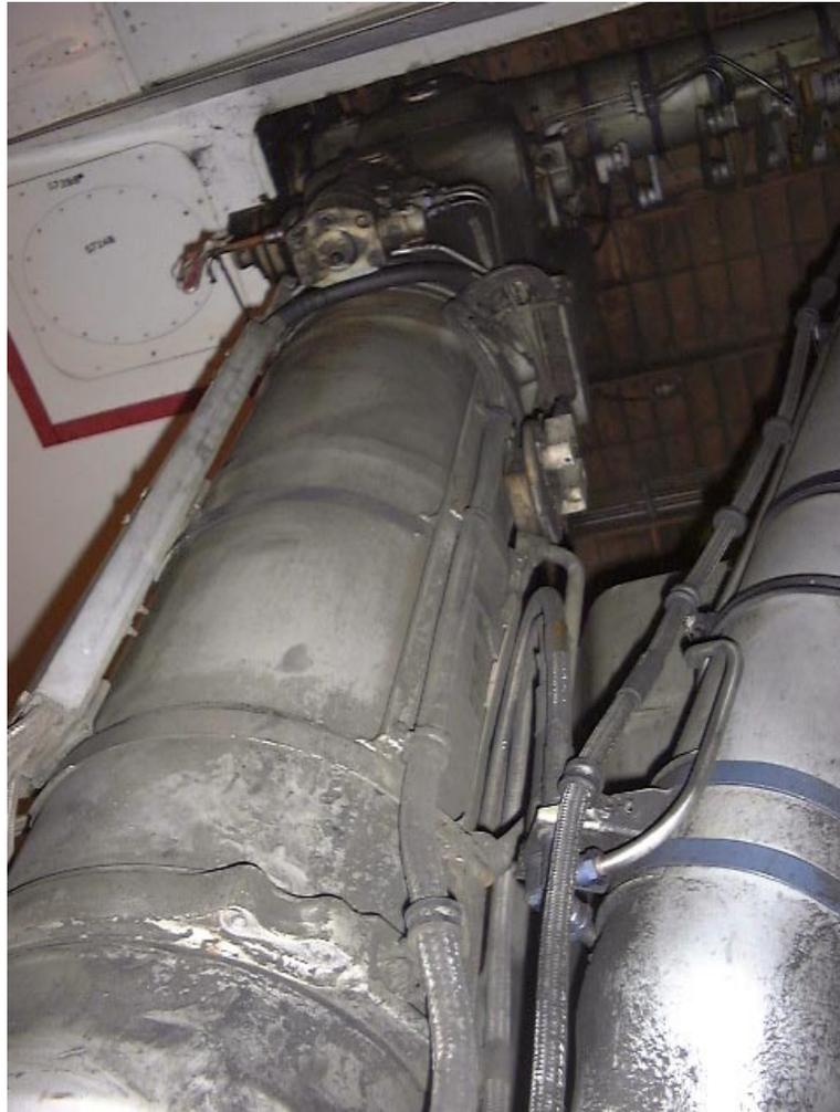
**Figure 23:** Photographie de la jambe du train principal gauche d'un Concorde. L'avant de l'appareil est vers la gauche de l'image. Les câbles d'alimentation des ventilateurs de roues descendent le long de la face arrière de la jambe. Photographie BEA prise sur un Concorde d'Air France à Roissy le 8/12/2000.
