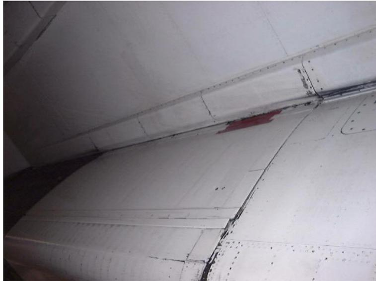
**Figure 40:** Photographie de détail du raccord entre la nacelle moteurs gauche et l'aile d'un Concorde, vu vers l'arrière de l'appareil. La partie sombre au centre de l'image et au raccord de l'aile correspond à la prise d'air du climatiseur. Photographie BEA prise sur un Concorde d'Air France à Roissy le 8/12/2000.
