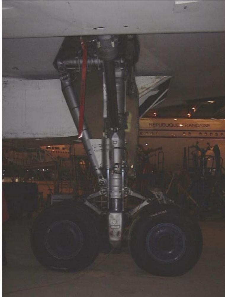
**Figure 22:** Photographie du train principal gauche d'un Concorde vu vers la gauche de l'appareil. La roue numéro 2, incriminée dans l'accident de Gonesse est la roue au premier plan à droite. Les roues en cause dans l'accident de Washington (14 juin 1979) sont les deux roues arrières du train (5 et 6). Photographie BEA prise sur un Concorde d'Air France à Roissy le 8/12/2000.
