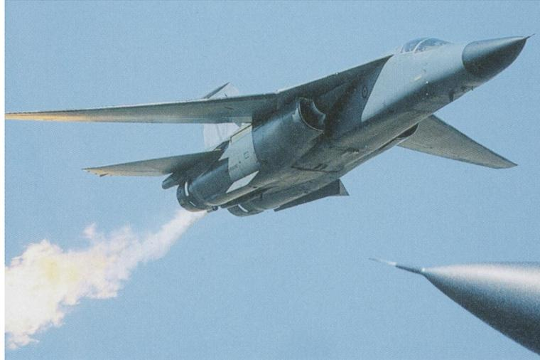
**Figure 59:** Photographie illustrant une figure de voltige aérienne connue sous le nom de “zipper trick”. Du carburant largué par l’avion est ensuite enflammé par la post-combustion du moteur. Photographie extraite de la revue allemande “Flug Revue”, numéro d’Avril 2001.
