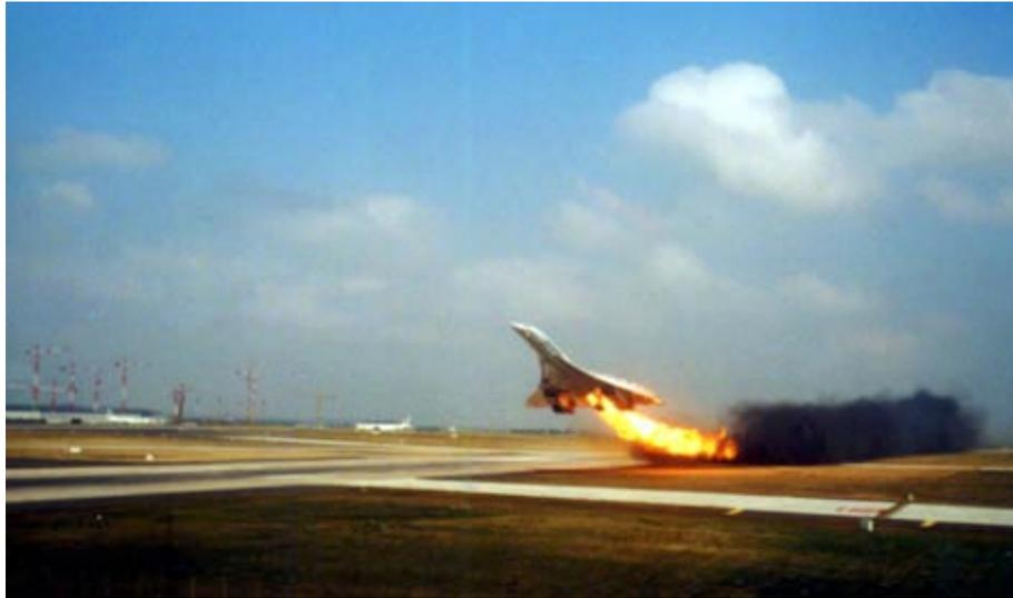
**Figure 14:** Photographie de l'avion après le décollage. La combustion, clairement incomplète, donne lieu à la formation de beaucoup de suies (particules de carbone imbrûlées) d'où sa couleur jaune. Le panache de suies noires est particulièrement visible derrière la flamme. Photographie prise par un touriste japonais depuis un avion en attente de traversée de la piste 26 R.
