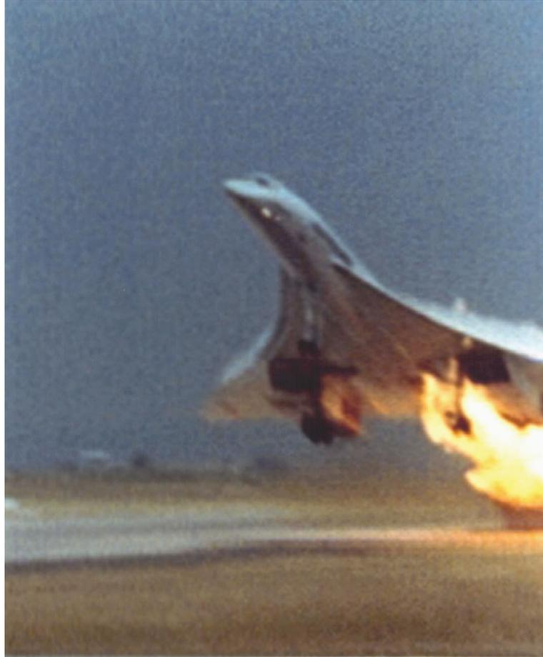
**Figure 2:** Photographie de l'avion après le décollage. La flamme semble accrochée dans le sillage des fûts du train d'atterrissage gauche. Source : Agence Sygma.
