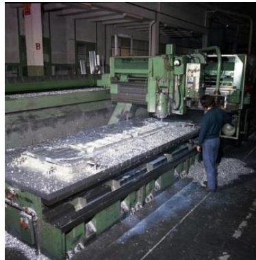
Fraisage d'un panneau. Le bloc d'aluminium AU2GN est placé sur la machine puis fraisé et apprêté
