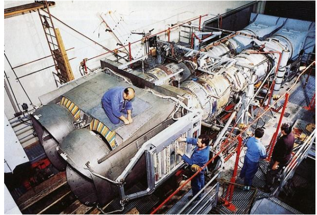
Première TRA testée au banc d'essai du Centre d'Essais des Propulseurs de Saclay avant d'être montée sur le présérie 02
