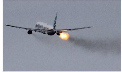
Un autre gros défaut, moins spectaculaire, mais plus fréquent, concernait les vaporiseurs des chambres de combustion, qui vieillissaient à l'époque très vite, et s'effritaient en libérant dans les turbines des morceaux de métal. Les ailettes de turbine avaient horreur de ça, d'autant que la perte d'un vaporiseur produisait aussitôt un effet de chalumeau sur les turbines, qui avait rapidement pour effet de les réduire en miettes, elles aussi.
