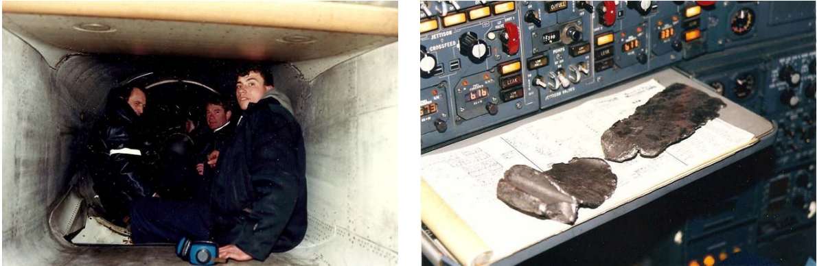
Gérard Dumontel et 2 autres mécaniciens de Mach2 Maintenance inspectent à Kennedy le moteur 4. Sur la « table » mécanicien, quelques ailettes endommagées
