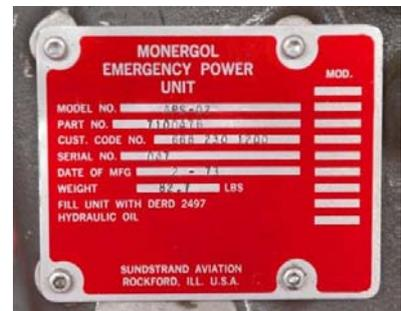
Fonctionnement : la percussion d'une cartouche lance le groupe et réchauffe la chambre. Ensuite, l'hydrazine est injectée directement dans la chambre par de l'azote sous pression contenu dans une bouteille percutée en séquence.
