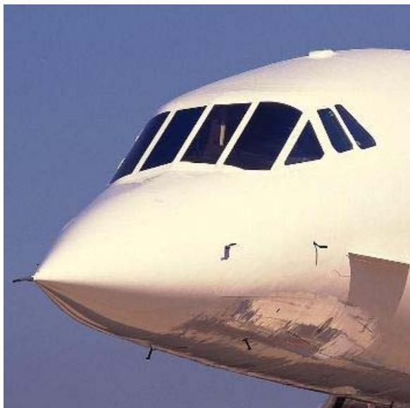
Dessiné aujourd'hui, Concorde serait sans doute équipé d'un système optique (télévision ?) permettant d'éviter le complexe basculement du nez.
