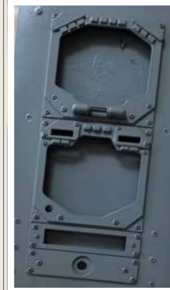
Assemblage en sandwich de plaques successives. Peinture-positionnement des vis.
