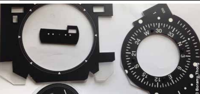
Positionnement de l'unité de rétro-éclairage dans l'horizon artificiel (carton + Feuille de plexiglass)
