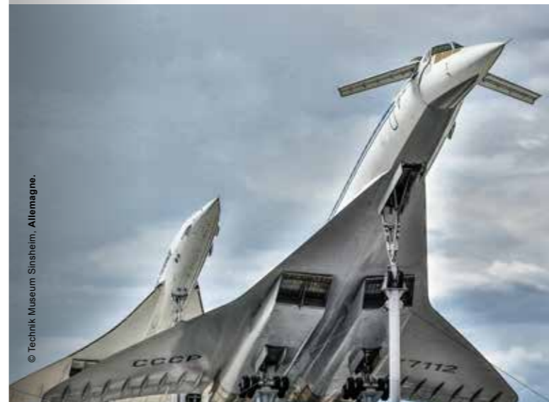
Au premier plan, un TU 144, les «moustaches» déployées. Surfaces portantes rétractables placées à l'arrière du cockpit également appelées plans canard.
