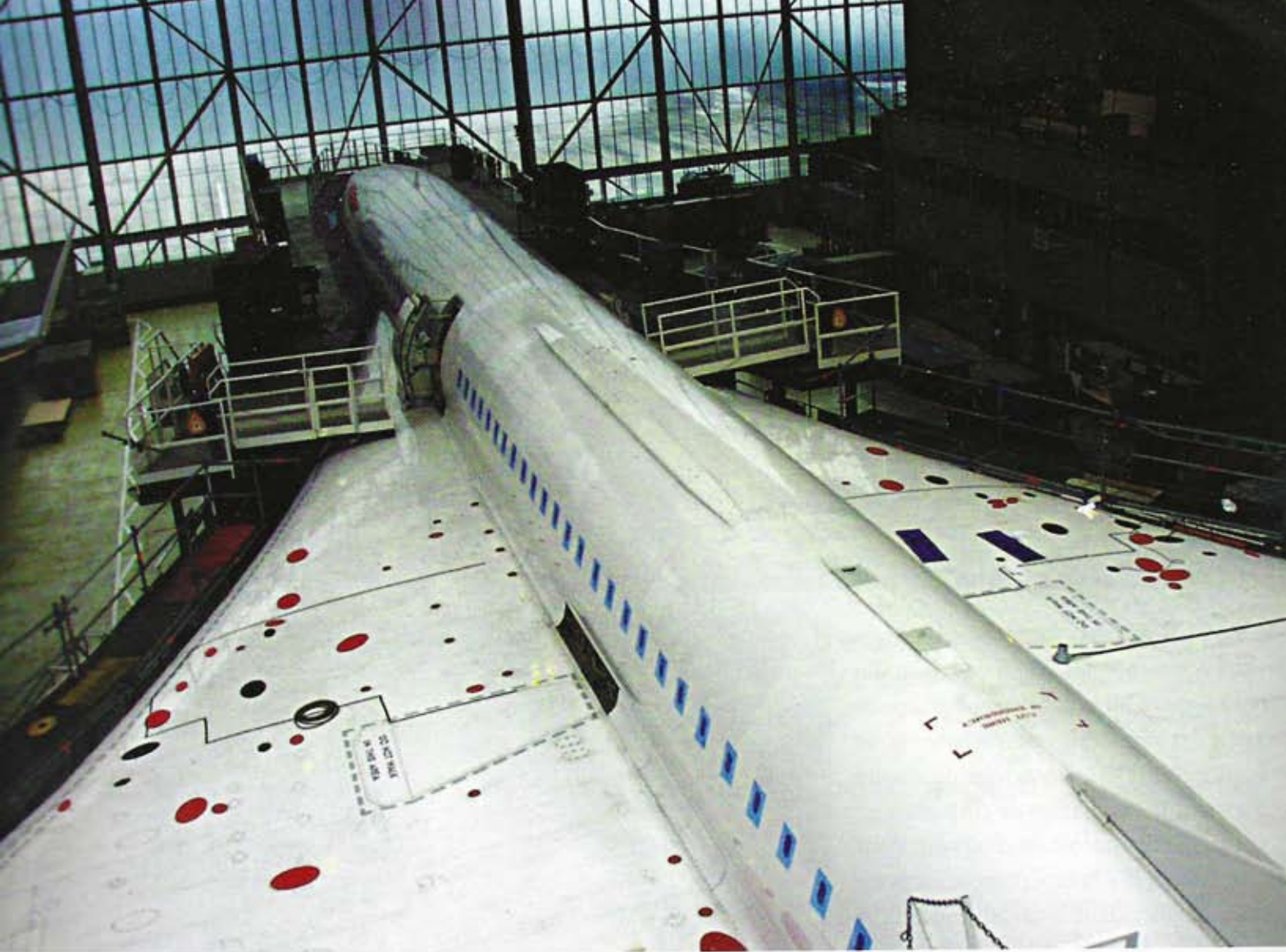
Vue supérieure de l'aile avec toutes les portes de visites permettant l'accès aux réservoirs de carburant.
