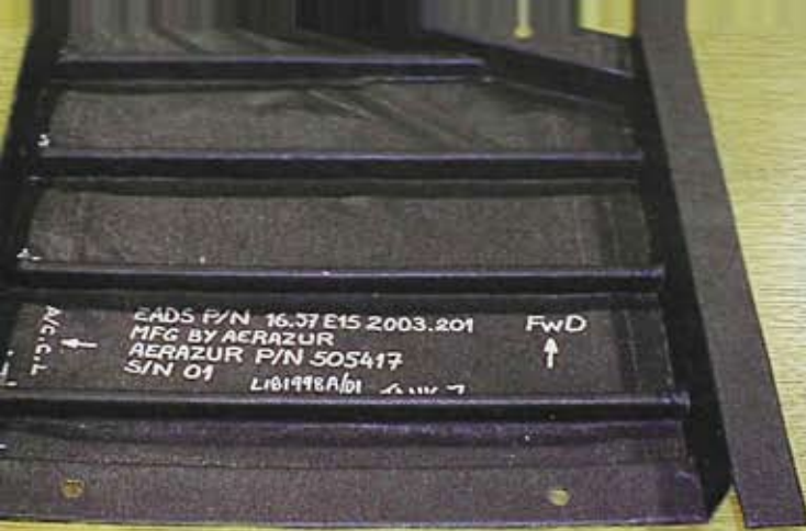
« Tankliner » avant la dans le réservoir.
