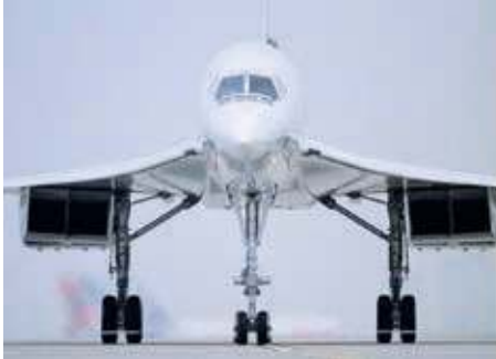
Concorde propulsé par quatre moteurs Bristol/Siddeley Olympus 593, version civile des moteurs de l'Avro Vulcan. Poussée : 150 kN sec (170 kN PC).
