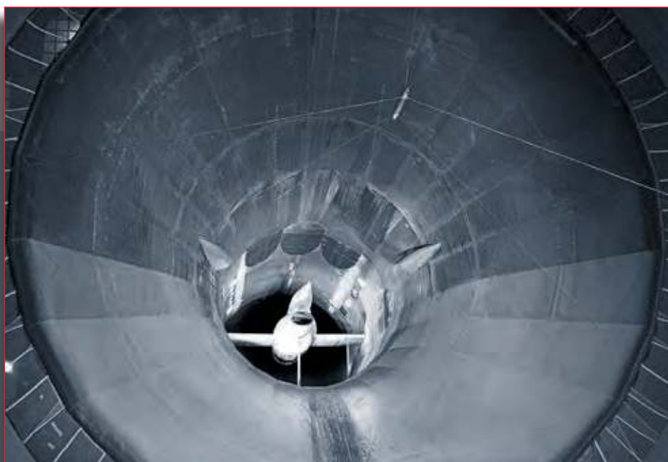
Le Griffon dans la veine de la soufflerie S1 de l'ONERA (8 mètres de diamètre) au site de Modane. Un essai de contrôle global est réalisé sur le fuselage. The Griffon in the ONERA S1 wind tunnel (with an 8-metre diameter) at the Modane site. An overall control test is being carried out on the fuselage. Photo © ONERA
