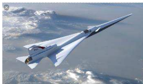
Projet Quiet SST Démonstrateur de la NASA visant à atténuer le bang pour pouvoir survoler les terres.
