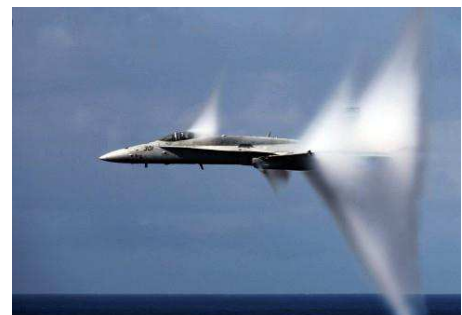
Chasseur F18 en supersonique, l'humidité de l'air permet de visualiser les ondes de choc
