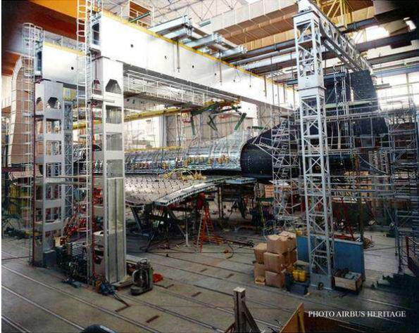
Cette photo montre l'installation, au CEAT, de la cellule d'essais de Concorde dont les équipements ont par ailleurs subi tous les tests cités plus haut. Il a fallu développer de nouveaux moyens et bancs d'essais en relation avec le domaine de vol spécifié de Concorde. Par exemple, à Mach2 prolongé, des contraintes thermiques se développent dans la cellule. Pour reproduire ces contraintes sur la cellule d'essais, une installation électrique spécifique de 30 000 kW a été mise au point.
