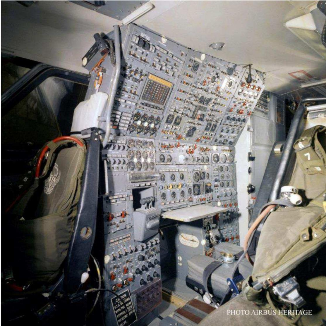
**Vue inhabituelle du poste de mécanicien du prototype 001 depuis la place du pilote.**
