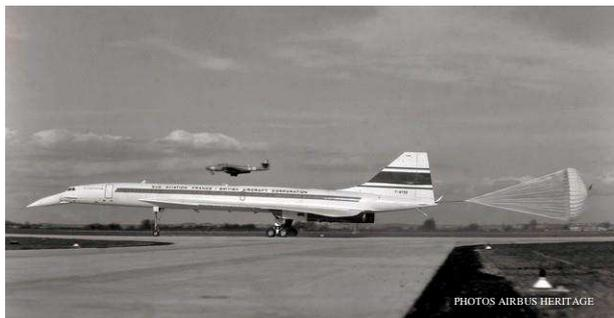
**A l'issue de ce vol consistant en un grand tour de piste de 29 minutes, Concorde 001 se pose à la vitesse d'environ 300 km/h. Le parachute d'aide au freinage est déployé.**
