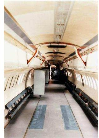
**Vue depuis l'arrière de la cabine du prototype 001. De nombreux autres équipements d'essais, semblables à celui présent à gauche de la photo, étaient installés de chaque côté de la cabine.**
