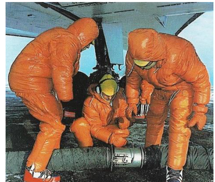
Mise en place de l'alimentation en air chaud de la cabine par les équipes Aérospatiale déguisées en « bibendum » rouges et affrontant des températures inférieures à -40°C. Photo Icare.
