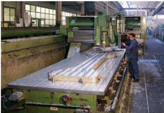
Fraisage d'un panneau. Le bloc d'aluminium AU2GN est placé sur la machine puis fraisé et apprêté
