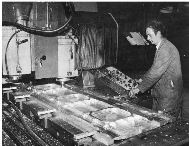
Fraisage d'un panneau de hublots (Photos PNCA)
