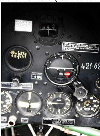
Le temps que « mon » pilote se harnache, je visualise les instruments sur le panneau : alti, compte tour, pression / température huile, température culasse, compas, horizon. A gauche au niveau de l'assise du siège, des manettes : volets, trains, trim profondeur, pompe injection. Au niveau de la glissière de la verrière les commandes mixture, puissance et un peu plus en avant les sélecteurs des magnétos et des réservoirs de carburant. Casque sur la tête, essai radio et interphone BFG
