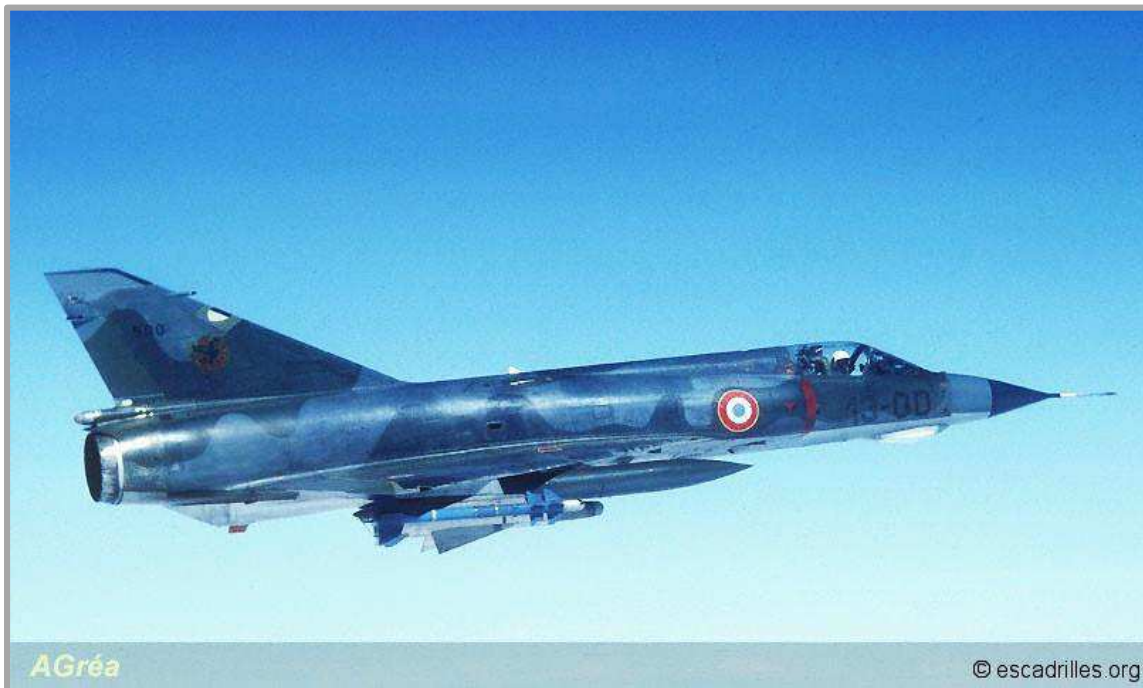
Mirage IIIIE du 1/13 Artois basé à Colmar. Equipé de 2 réservoirs pendulaires de 500 litres supersoniques et non largables Missiles Magic 1 d'entraînement (couleur bleue)
