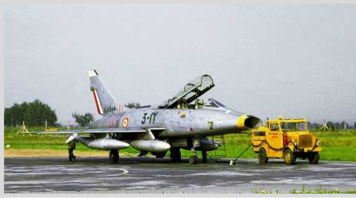
F100 F biplace et le véhicule de servitude MA2 : groupe électrique et pneumatique de démarrage
