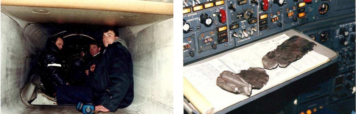
**Gérard Dumontel et 2 autres mécaniciens de Mach2 Maintenance inspectent à Kennedy le moteur 4.
