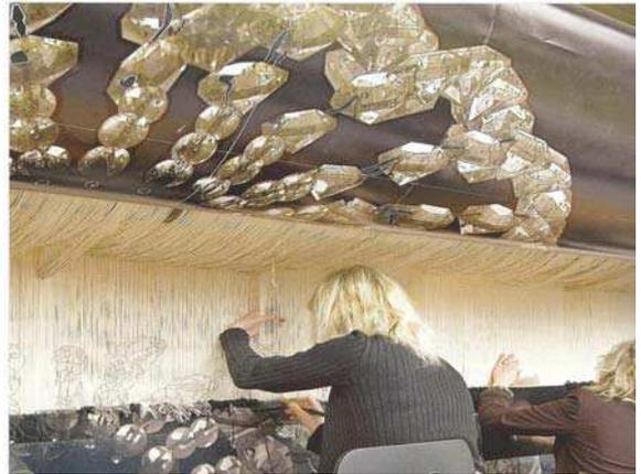
La Savonnerie utilise un métier à tisser de « haute lisse » identique à celui des Gobelins mais en utilisant une technique différente, en formant un nœud sur l'envers de l'ouvrage et une boucle sur l'endroit qui sera tondu pour obtenir un velours. Au fur et à mesure de l'avancement de l'ouvrage, le lissier le tond puis démêle les poils et les range à la pointe du ciseau pour obtenir un fini parfait. Le lissier travaille sur l'endroit du tapis, le carton placé au dessus de lui face à la lumière.
