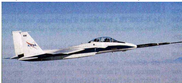
Essais de la perche de nez sur un F15B de la NASA
