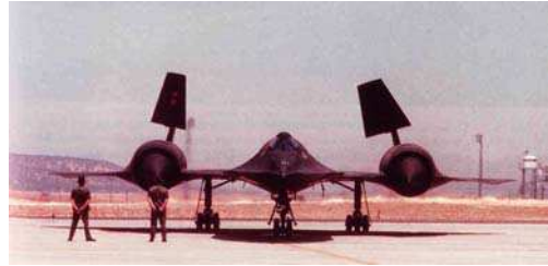
Essais gouvernes avant roulage. On voit l'important débattement des gouvernes de direction
