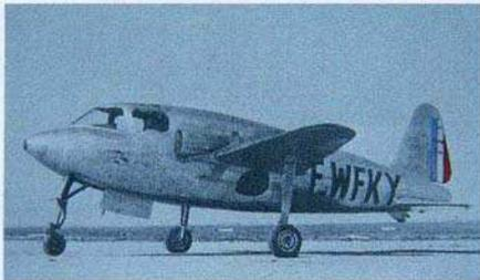
Le SO 6000 n° 04 équipé d'un réacteur Nene et muni d'entrées d'air latérales
