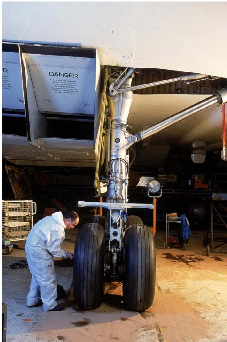
*Le vérin de relevage se trouve tout en haut de la jambe de train, en dessous vient la contrefiche. La robustesse de ce train, équipé de pneus Michelin a permis de décoller l'avion de 185 tonnes à 400 km/h pendant plus de trente ans avec une fiabilité totale.*
