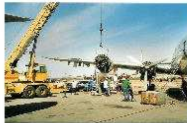
Remplacement du moteur 4
