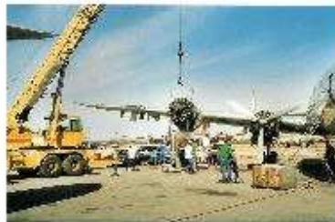
Remplacement du moteur 4
