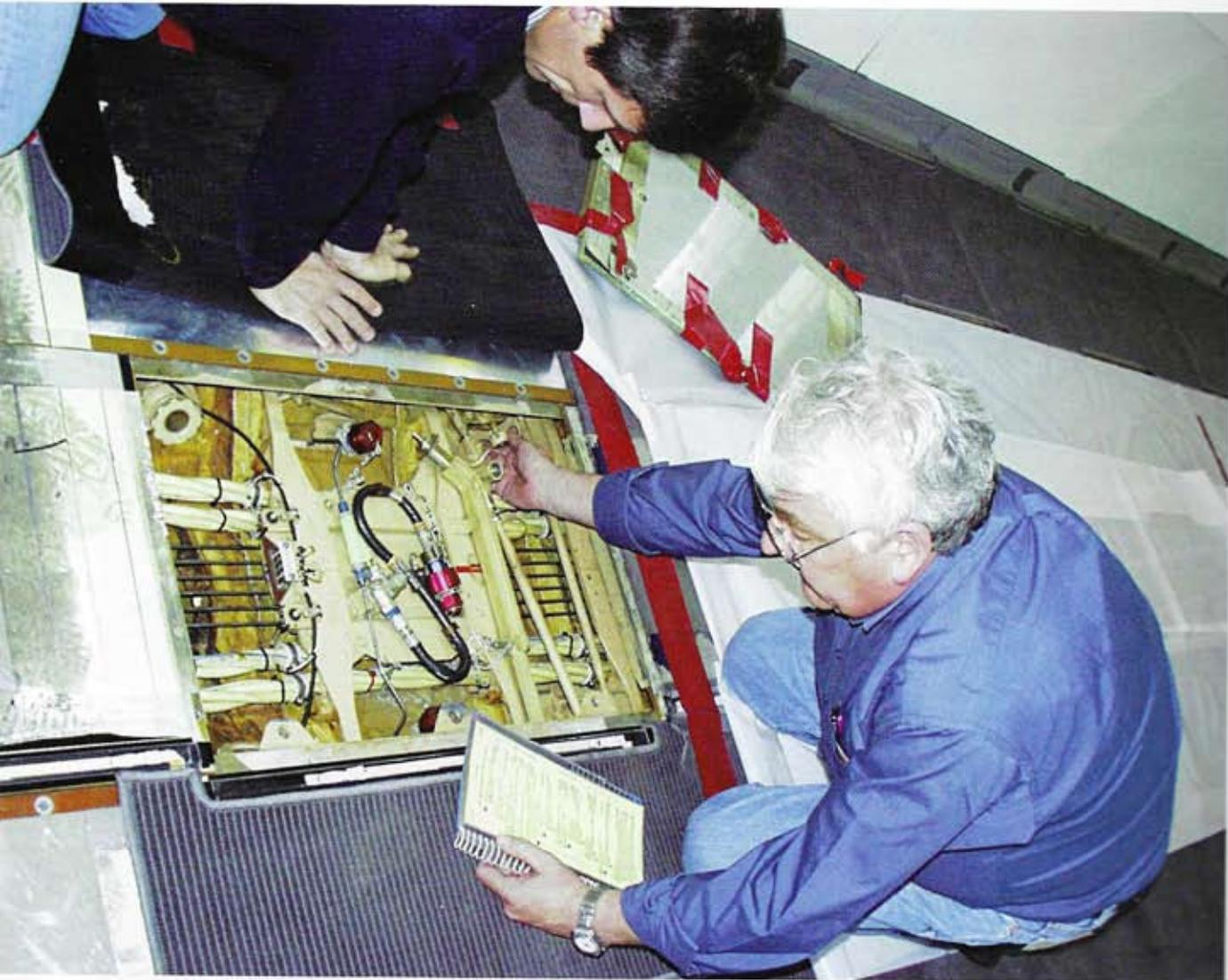
Vérification du circuit hydraulique.
