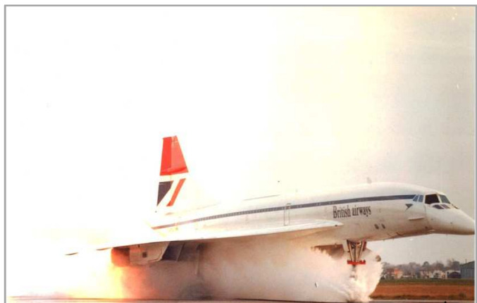
Le 02 (avec déflecteurs d'eau) lors des essais « piscine » à Toulouse. (Photo Y. Pingret)
