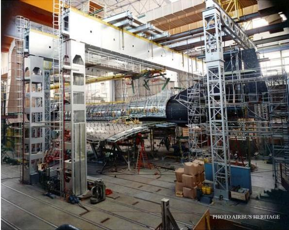
Cette photo montre l'installation, au CEAT, de la cellule d'essais de Concorde dont les équipements ont par ailleurs subi tous les tests cités plus haut. Il a fallu développer de nouveaux moyens et bancs d'essais en relation avec le domaine de vol spécifique de Concorde. Par exemple, à Mach2 prolongé, des contraintes thermiques se développent dans la cellule. Pour reproduire ces contraintes sur la cellule d'essais, une installation électrique spécifique de 30 000 kW a été mise au point.
